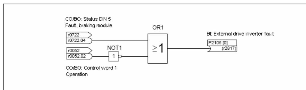
Operating a MASTERDRIVES braking unit with a MICROMASTER ID-No: 22093967
